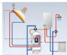
Schema di collegamento con caldaia in serie
